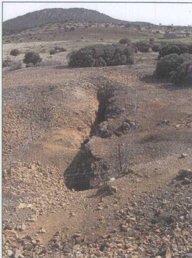
VE005.- Labor de explotación por realce parcialmente rellena.
