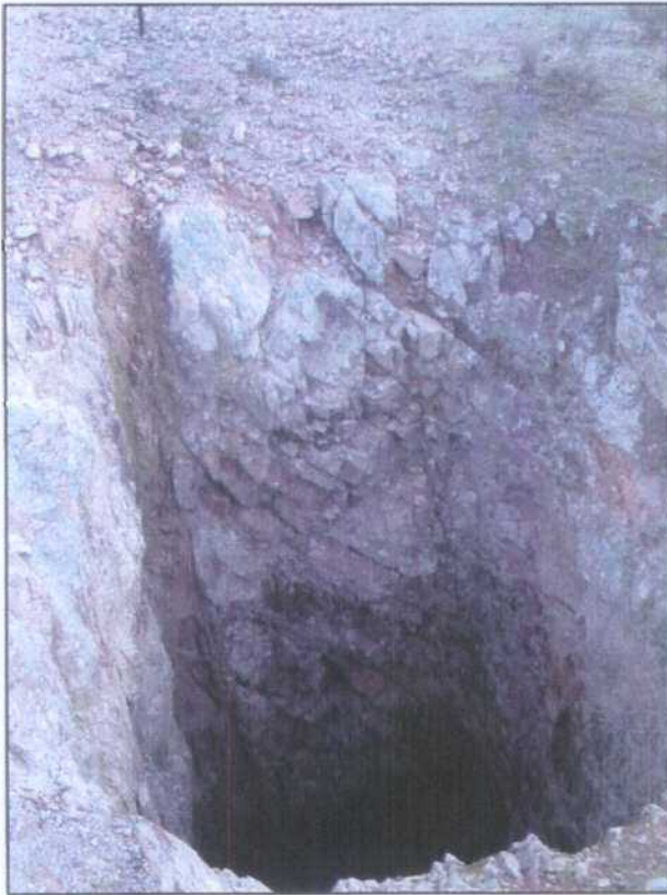
GJ005.- Pozo de reconocimiento sobre filón, en el que se puede ver la estructura mineralizada.
