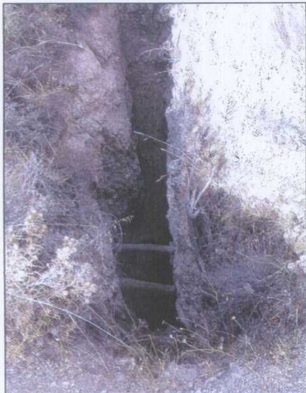
ST006.- Explotación en realce llevada hasta la superficie. Se pueden ver algunos palos utilizados para acceder a las partes altas de los trabajos.
